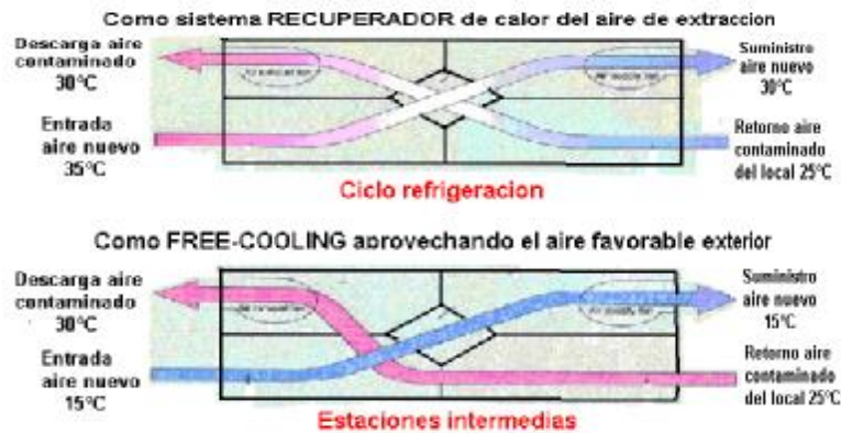
Figura 18. Recuperación de calor y free-cooling conjuntos
