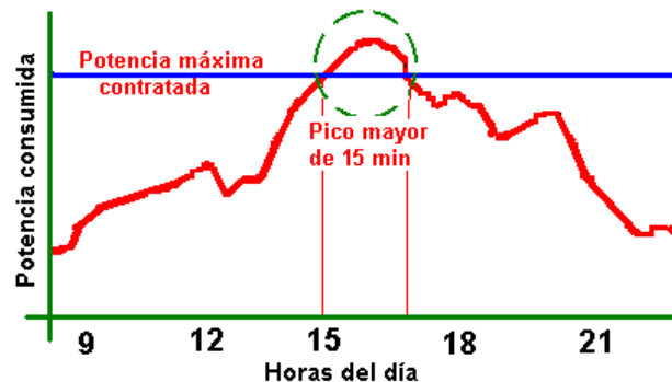
Figura 29. Penalizaciones por superar la potencia eléctrica máxima contratada
