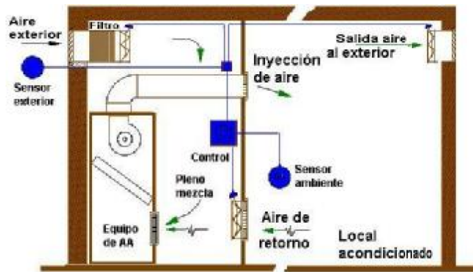
Figura 9. Esquema sencillo de aplicación de un free-cooling
